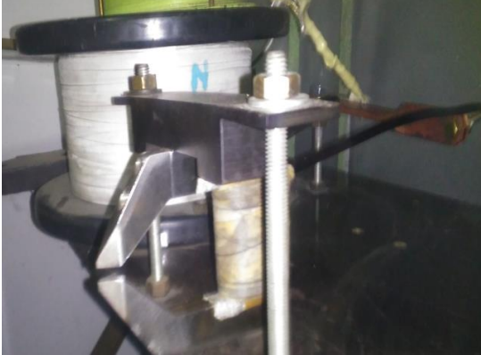
Sistem de magnetizare pentru concentrare locală Montarea magnetului pentru magnetizare Fig. 9. Magnetizarea magneților permanenți.
