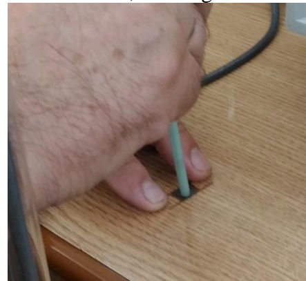
Masurarea cu sonda perpendiculara
